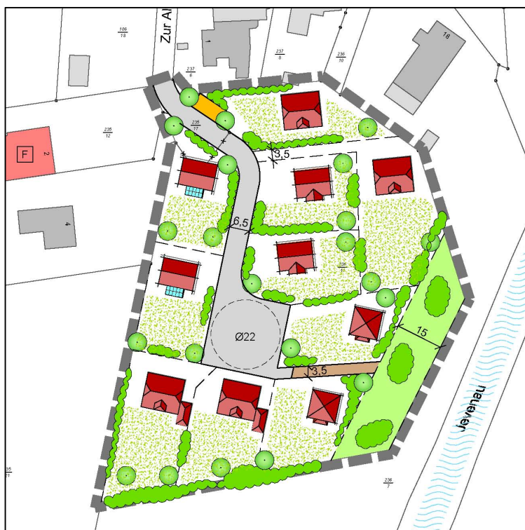
Abbildung 1: Städtebauliches Konzept, Quelle: Ingenieurbüro GSP
