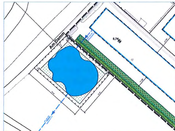
Abb. 15: Löschwasserteich – Feb. 2019 – Petersen&Part. Ing.
