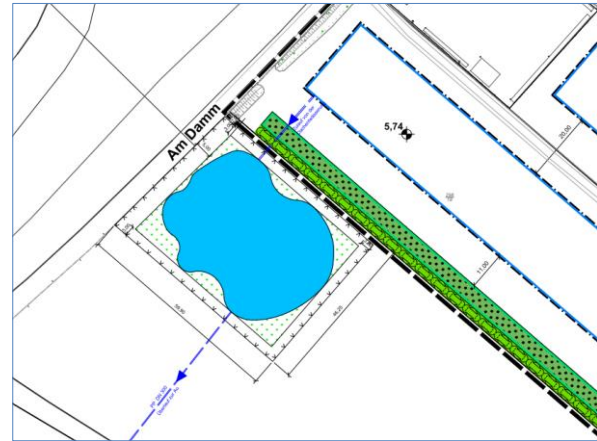
Abb. 15: Löschwasserteich – Feb. 2019 – Petersen&amp;Part. Ing.
